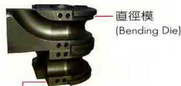
直徑模 (拉彎) (Bending Die/Draw Bending)
